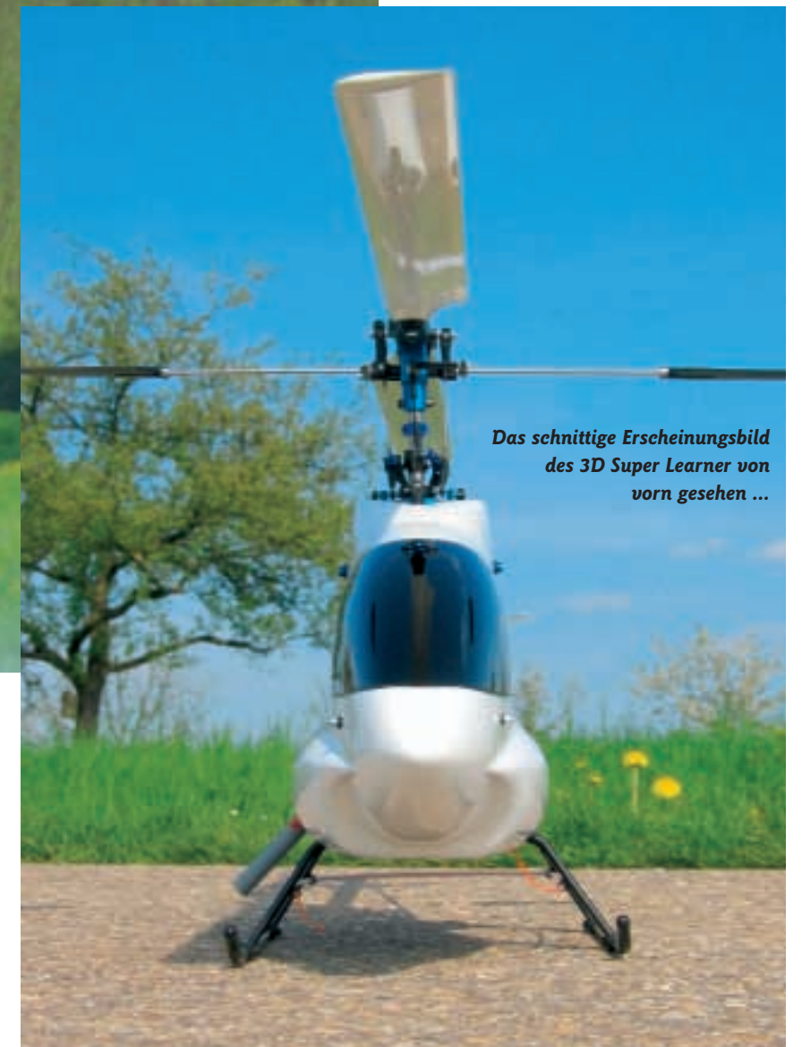
Der Hauptrotorkopf mit unten liegender Paddelstange, Alu-Zentralstück und Kunststoff-Blattgriffen
