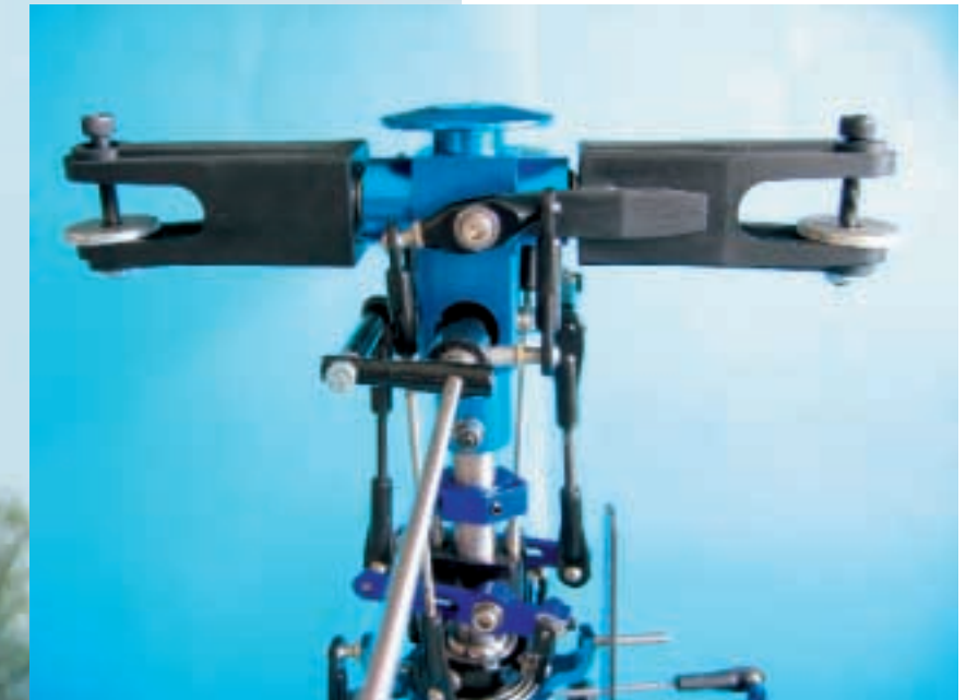
Der Hauptrotorkopf mit unten liegender Paddelstange, Alu-Zentralstück und Kunststoff-Blattgriffen
